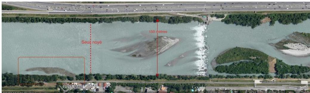
Afin de réduire les risques d'inondation en cas de crue exceptionnelle (sur demande de la préfecture) et pour garantir la continuité alluvionnaire et piscicole, l'ILL a conduit en qualité de maître d'ouvrage les travaux visant à abaisser le niveau de son seuil sur le Drac de 80 cm, et aménager 2 passes à poissons, une côté Fontaine et une côté Presqu'île.
